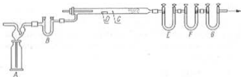
Rys. 3.22. Oznaczenie wody przez suszenie w strumieniu powietrza
