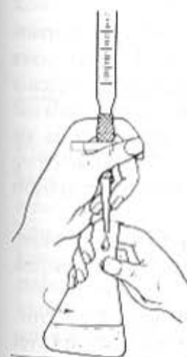
Rys. 2.14. Technika wykonania miareczkowania
