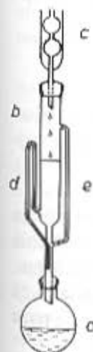
Rys. 5.14. Ekstraktor Soxhleta do ekstrakcji substancji stałych
