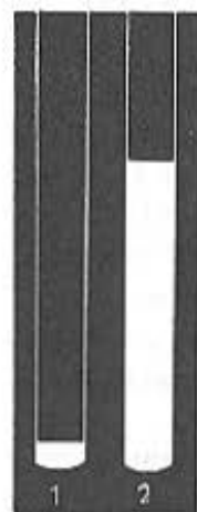
Rys. 3.8. Objętość jodanu toru; 1 — wytrąconego z roztworu jednorodnego, 2 — wytrącanego metodą klasyczną
