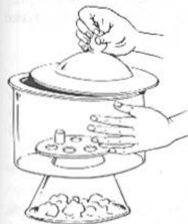
Rys. 3.17. Otwieranie eksykatora
